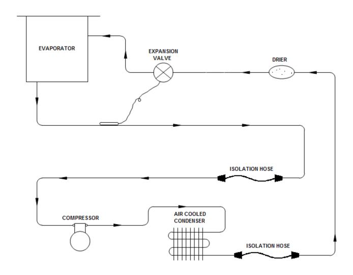
FIGURE 4-10, REFRIGERATION FLOW DIAGRAM
