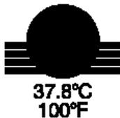
**Temperatura média.** Premir este interruptor irá ativar a unidade para atrair o ar da sala, aquecer o ar até 37,8°C +4,0°C/ -2,0°C e fornecê-lo ao doente através do cobertor descartável. O LED será ativado para indicar que a unidade está no modo de temperatura média.
