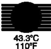
**Temperatura alta.** Premir este interruptor irá ativar a unidade para atrair o ar da sala, aquecer o ar até 43,3°C +4,0°C/ -2,0°C e fornecê-lo ao utente através do cobertor descartável. O LED será ativado para indicar que a unidade está no modo de temperatura alta. A definição de temperatura alta deve ser utilizada com observação próxima do utente.
