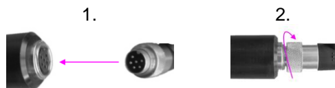
Мал. 7 Підключення профілю нагріву
