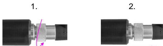
Мал. 10 Від'єднання профілю нагріву від блоку Управління
