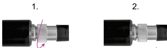
Fig. 10 séparation du profilé chauffant de l'unité de commande
