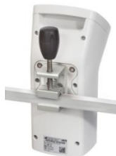
III. 5 Fastgørelse på en standardskinne til medicinsk udstyr
